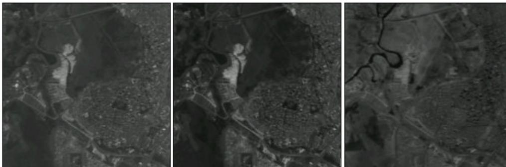
**Figura 12 - Bandas sintéticas geradas usando coeficientes de correlação localmente adaptáveis**
