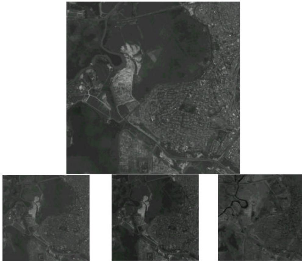
**Figura 5 - Imagens-teste originais do SPOT: a banda pancromática (P, no alto) e as três bandas multiespectrais (B1, B2 e B3)**
