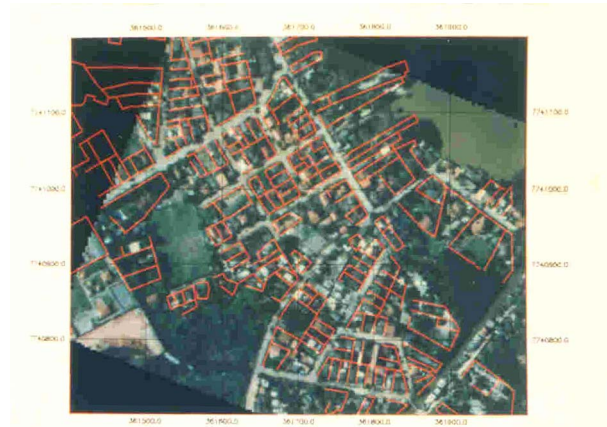
fig.6: superposição de arquivo DXF com imagem corrigida, na escala 1/10.000
