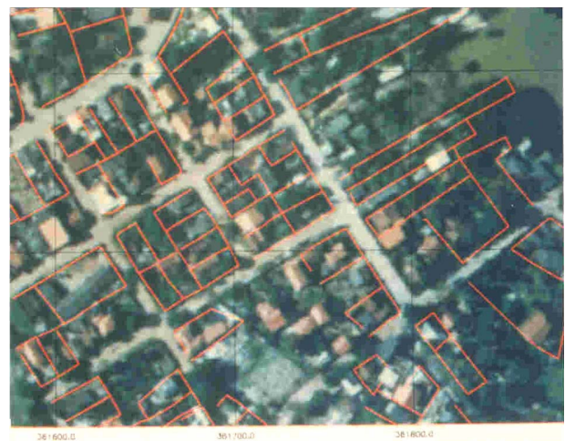
fig.7: detalhe da superposição de arquivo DXF gerado por Restituição Aerofotogramétrica sobre uma imagem não métrica corrigida, na escala 1/4.000
