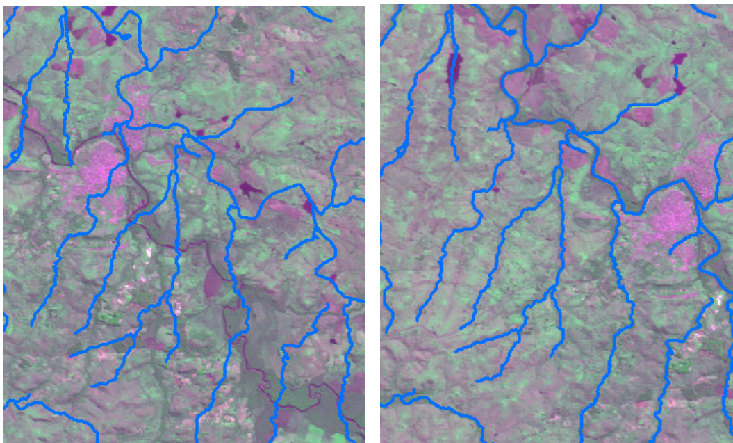
Figura 1. Detalhe do georreferenciamento de composição 3-4-2 de imagens CBERS com base na rede hidrográfica digital
