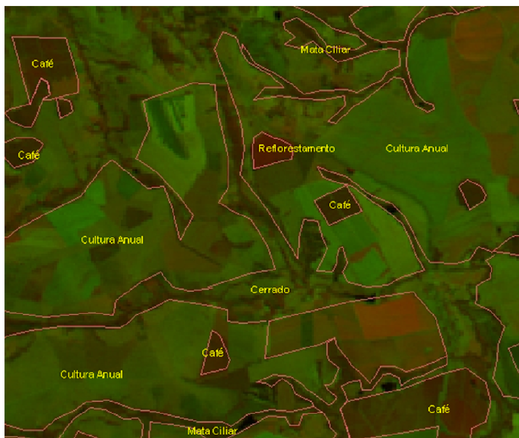
Figura 3 – Amostra da Classificação de imagem TM/Landsat 5, composição 3(B)4(R)5(G).
