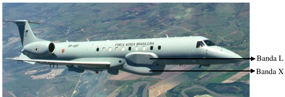
Figura 2. Sensores SAR instalados na aeronave R99-Bravo.
