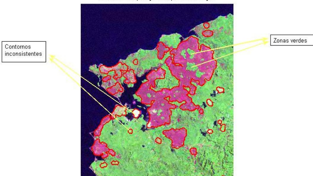
**Figura 7: Composição colorida de imagens TM (canais 3,4 e 5) Juntamente com os contornos obtidos pela aplicação do operador de dilatação no final do processo. Observa-se um aumento na área contornada. Porém este resultado vem acompanhado por novos efeitos, dentre os quais mostra-se o aumento dos contornos inconsistentes e a inclusão de zonas verdes dentro dos contornos.**
