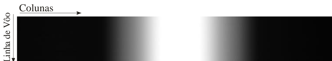
Figura 1: Imagem, em tons de cinza, obtida com o sensor HSS de um painel de Spectralon iluminado por duas lâmpadas de filamento de tungstênio. Na medição foi utilizado o IFOV de 2,5 mrad e uma frequência de varredura de 6,25 Hz. Na vertical são mostradas as 150 linhas e na horizontal 720 colunas correspondentes ao FOV de 86° do sensor.
