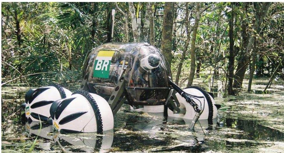
**Figura 1** – Robô Ambiental Híbrido em região alagada coletando amostras de água com seu braço robótico.
