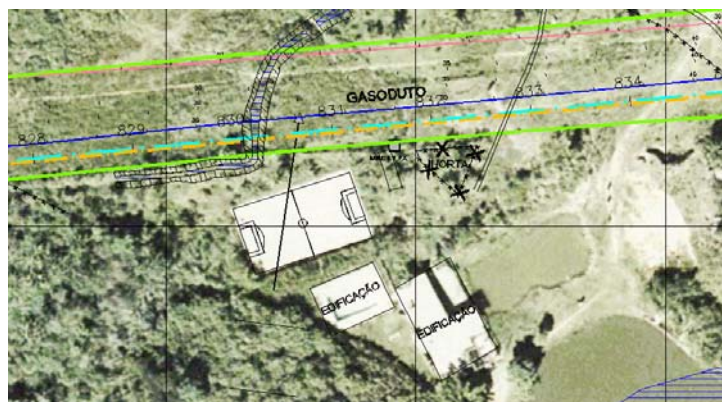
Figura 04 – Ortofoto evidenciando a presença de edificações próximas ao duto.
