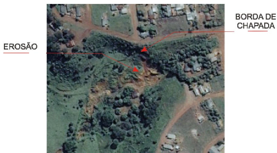
Figura 3 – Erosão em 2001, essa erosão foi caracterizada como erosão em cabeceira de drenagem, do tipo voçoroca.
