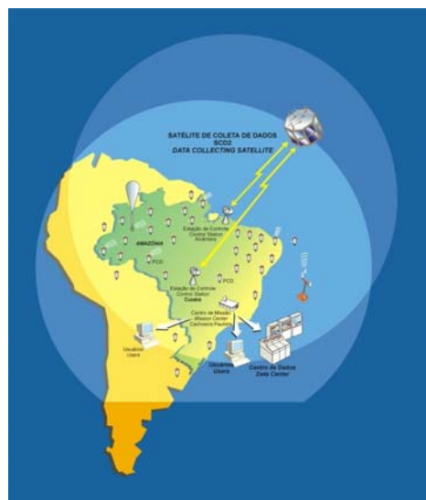
Fig.1 – Sistema Brasileiro de Coleta de Dados Ambientais, mostrando os círculos de visibilidade das estações de Cuiabá e de Alcântara.
