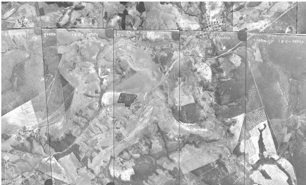
Figura 2 – Mosaico semi-controlado parcial da bacia do rio Corumbataí. Mapa base em escala 1:25.000
