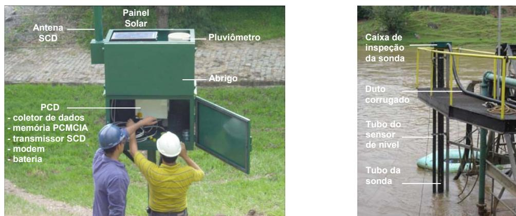
**Figura 2** – Detalhes da instalação da PCD de qualidade de água
