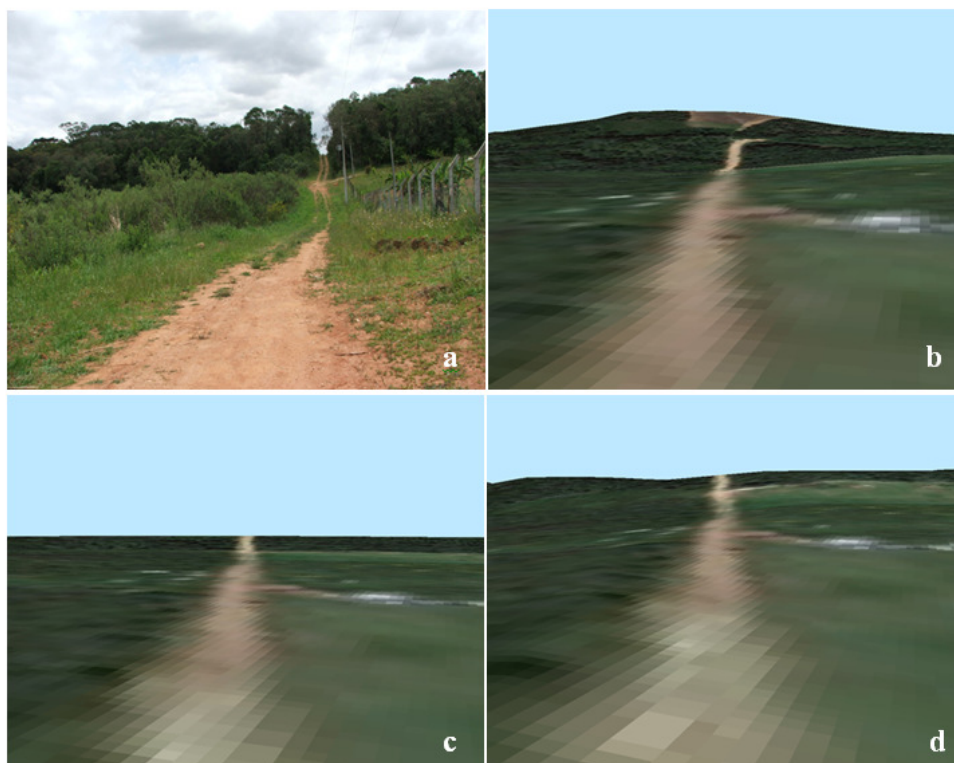
Figura 10. (a) Fotografia. (b) Modelo 3D ASTER GDEM. (c) Modelo 3D SRTM. (d) Modelo 3D Carta Topográfica.
